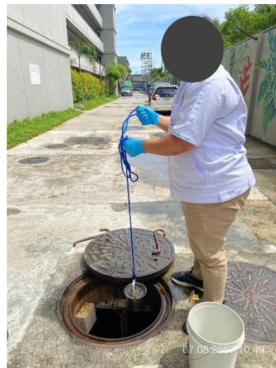
ภาพที่ 72 แสดงจุดเก็บน้ำทิ้งหลังบำบัด (Effluent)
